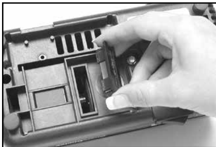
18. ábra A készülék alján lévő fedőlap eltávolítása a fémhulladék kitarításához (lásd Szabályszerű karbantartás részt)
