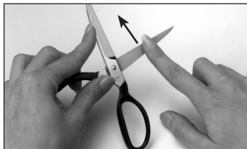
5. ábra: Óvatosan ellenőrizze a sorját a penge egész hátoldalának hosszában. Figyelje a nyilat, ami mutatja, hogy merre kell mozgatni az ujjat, amikor érintkezésbe lép a pengével.
